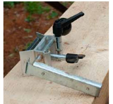
Selon Gérard Saulnier le support de grume - U417 est un accessoire qui augmente la précision du sciage et qui facilite le sciage des grumes courtes.
