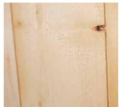
Une planche rêche sciée avec une scierie à ruban entourée de planches lisses sciées avec une scierie à chaîne.
