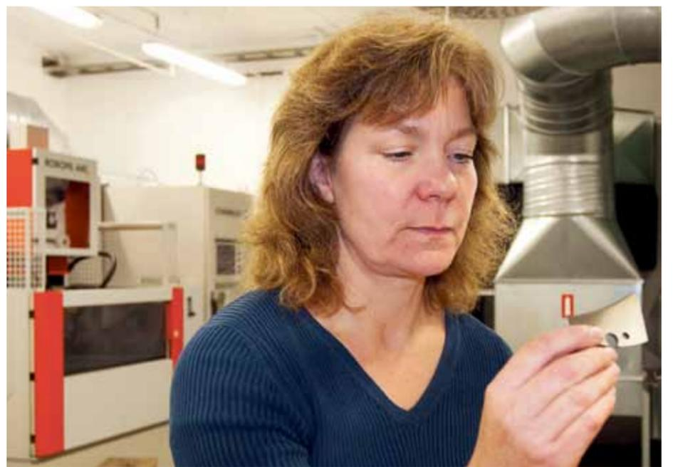
Maria Linder contrôle un fer après l'électro-érosion. L'ensemble du processus se déroule avec une grande exactitude, il est entièrement piloté par ordinateur.
