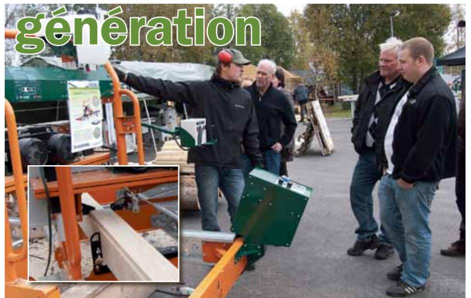
Jonas Höglund, concepteur chez Logosol, fait une démonstration de la nouvelle avance de l'unité de scie à ruban LM Pro. Photo insérée : Les volets se déploient derrière la lame de la scie.
