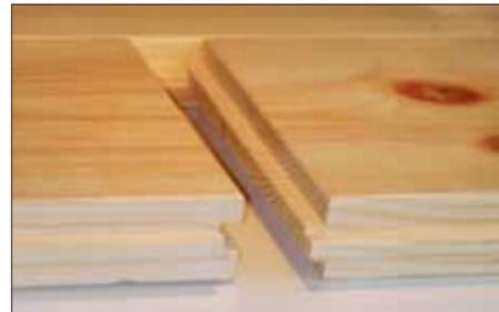
**Le couteau de fraisage travaille deux panneaux de plancher à la fois, un avec une languette et l'autre avec une rainure.**
