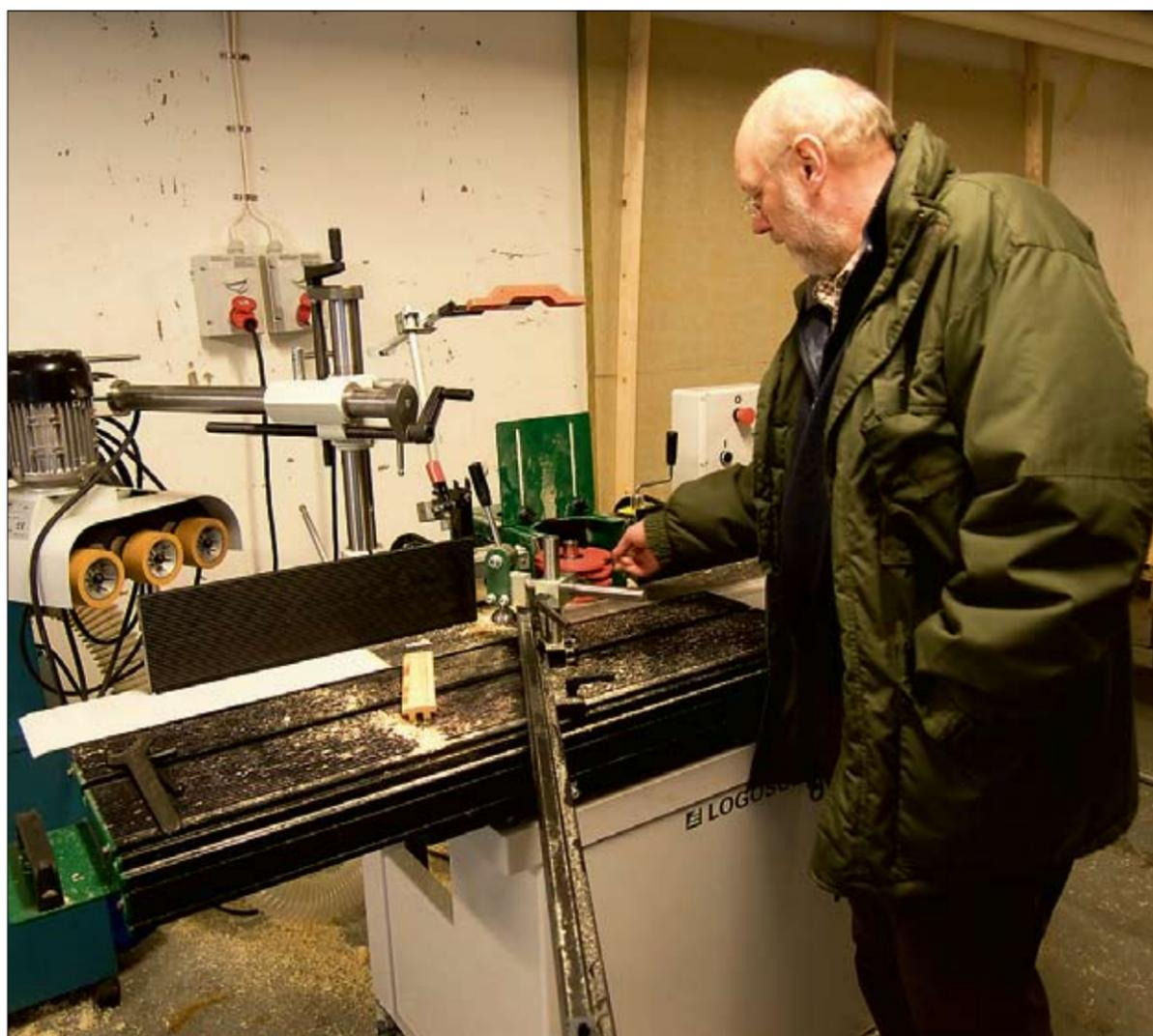
*« La toupie verticale est la machine idéale pour un innovateur. C'est ici que je fais des essais d'angles et de profils », explique Runo Johansson au sujet de la Logosol MF30.*
