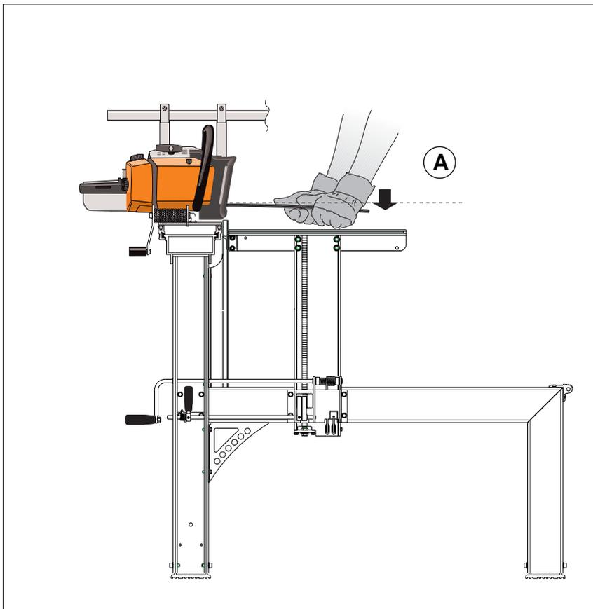
**Le guide-chaîne doit être parallèle au support à tronc.** Si ce n'est pas le cas, c'est probablement dû à ce que le guide-chaîne n'est pas droit. Déposer la chaîne et faire glisser la tronçonneuse, guide-chaîne posé, au-dessus du support.
