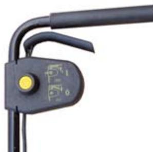
La commande de démarrage de la scie à ruban avec une « poignée d'homme mort ».
