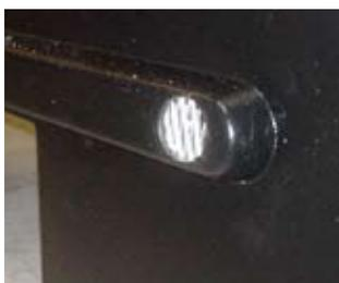
Un extracteur de copeaux intégré ! Comme vous pouvez le constater sur l'image à la section « Réglage des guides de lame », une barrière est située à l'avant de la roue d'entraînement pour créer un logement de ventilateur. La prise d'air au centre de la roue améliore la circulation de l'air. De la sciure s'accumule toujours dans les scies à ruban mais la conception de la machine réduit considérablement ce problème !
