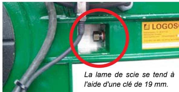
La lame de scie se tend à l'aide d'une clé de 19 mm.
